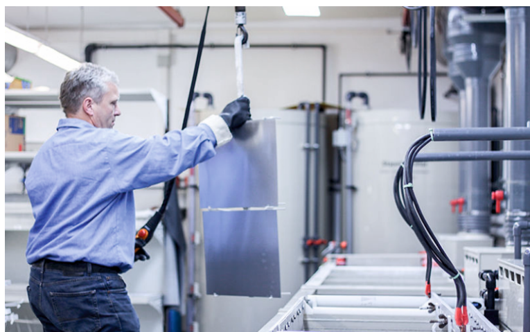
Bild: Produktion – Die eloxierten Aluminiumschilder werden bei uns im Eloxalunterdruckverfahren weiterbearbeitet.
